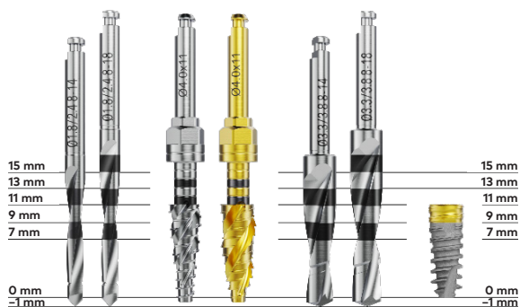
Figur B - Djupmarkeringsreferens på OsseoDirector™, OsseoShaper™ och Twist Step Drills
