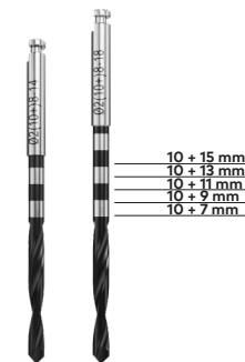
Figur D - Markeringar på Guided Pilot Drill
