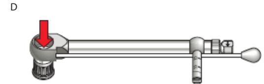
Рисунок D. Снятие переходника ручного хирургического динамометрического ключа Manual Torque Wrench Adapter
