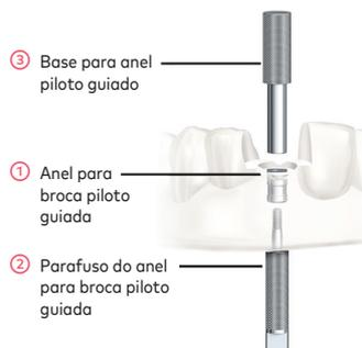
Figura A – Fixação do anel para broca piloto guiada
