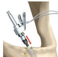
4. O indicador de ângulo do Instrumento de Alinhamento Multi-unit indica a posição do orifício do parafuso protético ao selecionar um pilar Multi-unit de 17° ou 30°. Posicione o Instrumento de Alinhamento Multi-unit de forma a que o indicador de ângulo fique perpendicular ao osso. O braço do Instrumento de Alinhamento Multi-unit perpendicular ao osso indica o pilar Multi-unit recomendado para utilização. A linha vermelha na **Figura 3** ilustra a opção 30°.
