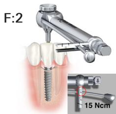
**Atenção:** no caso da Conical Connection 3.0, o torque de aperto protético do parafuso do pilar nunca deve ultrapassar os **15 Ncm**. O aperto excessivo do pilar pode provocar fraturas no parafuso.
