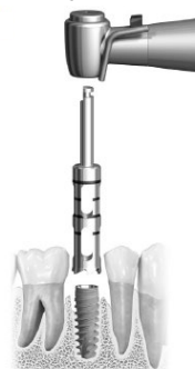
Figur F: Plasser trepanboret over implantatet
