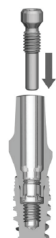
Figur E – Innsetting av Abutment Retrieval Instrument i distanse (eksempel med Abutment Retrieval Tool Titanium CC)
