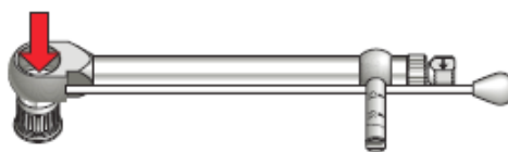
Afbeelding D: De Manual Torque Wrench Adapter verwijderen
