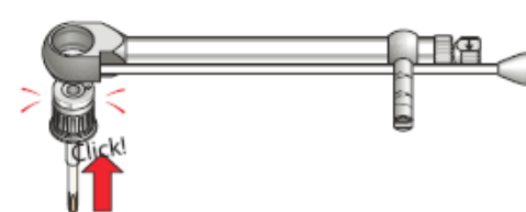
Afbeelding F: De adapter in de Manual Torque Wrench Adapter steken
