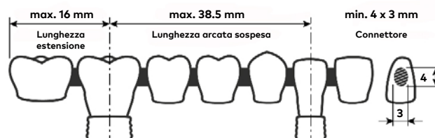
Figura B: Requisiti dimensionali per il ponte implantare in zirconia
