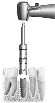
Figura F: Posizionamento della fresa Trepphine sull'impianto
