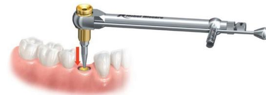
**Figura B: Posizionamento dello strumento di rimozione dell'impianto nell'impianto**
