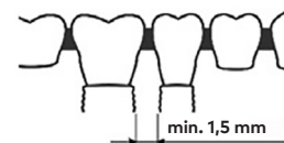
C.2 ábra – NobelProcera® Esthetic Zirconia Implant Bridge implantátumhíd, minimum távolságok az implantátumok között
