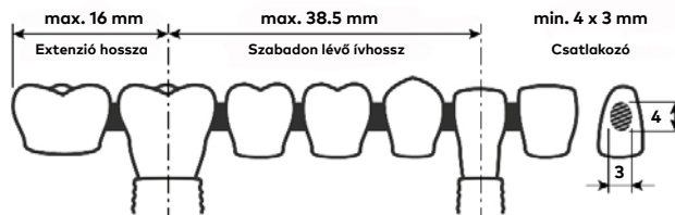
B ábra – A cirkon implantátumhidak méretkövetelményei
