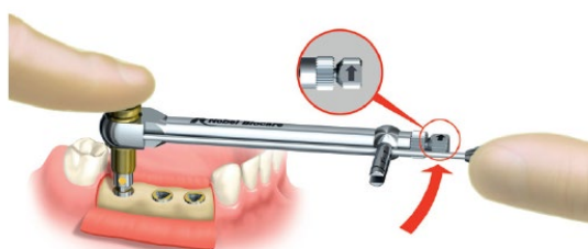
C ábra: Az implantátum kicsavarozása ellentétes irányba kapcsolt Manual Torque Wrench Surgical nyomatekkulccsal
