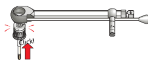
F ábra: Az adapter behelyezése a Manual Torque Wrench nyomatekkulcsba
