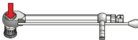
D ábra: A Manual Torque Wrench Adapter nyomatekkulcs-adapter eltávolítása
