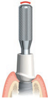
C ábra: A felépítmény meglazítása az Abutment Release Pin CC csap ide-oda mozgásával
