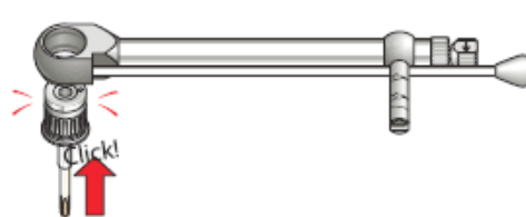
Kuva F: Liittimen yhdistäminen Manual Torque Wrench -momenttivääntimeen
