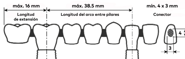
Figura B – Requisitos dimensionales para el puente de zirconia sobre implantes
