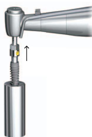
5. Coloque y apriete el implante. Para NobelActive® 3.0 utilice un torque de inserción máximo de **45 Ncm (D:1)** y para NobelActive® 3.5, 4.3, 5.0 y 5.5 utilice un torque de inserción máximo de **70 Ncm (D:2)**.
