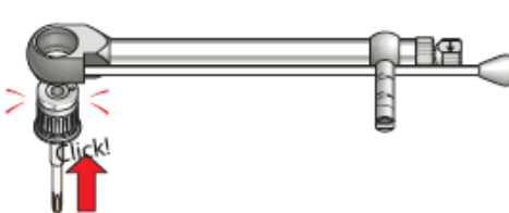
Figur F: Påsætning af adapter med Manual Torque Wrench
