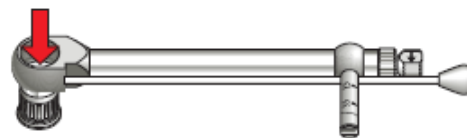
Figur D: Fjernelse af Manual Torque Wrench Adapter
