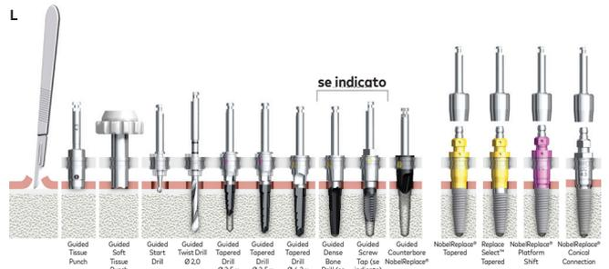
Figura L - Esempio di sequenza di fresatura completa per l'impianto Ø 4,3 RP 13 mm
