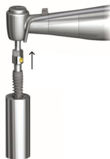
Figura C – Posizionamento del driver per impianto
