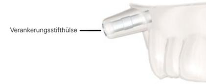
Abbildung 4: Einsetzen der Verankerungstiftshülse
