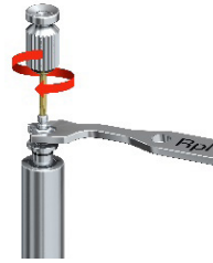
Abbildung C – Verwenden des Gegenhalters Einbringpfosten Guided zur Fixierung des Einbringpfostens
