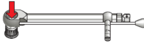
Figure D : Retrait de l'adaptateur de clé à torque manuelle
