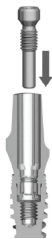
Figure C – insertion de l'instrument Abutment Retrieval Instrument dans un pilier (exemple avec l'outil Abutment Retrieval Tool Titanium CC)
