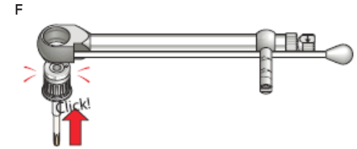
Abbildung F: Einrasten des Adapters an der manuellen Drehmomentratsche
