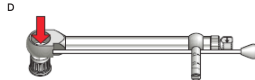
Abbildung D: Entfernen des Adapters für die manuelle Drehmomentratsche
