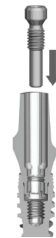
Abbildung E – Einsetzen des Abutment-Entfernungsinstruments in das Abutment (Beispiel mit dem Abutment-Entfernungsschlüssel Titan CC)
